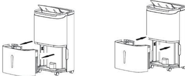
Achtung: Wenn der Wassertank voll ist, leeren Sie ihn. Bevor Sie den Wassertank zurück in das Gerät einsetzen, prüfen Sie, ob sich der Schwimmer flexibel drehen kann. Bringen Sie den Tank mit beiden Händen wieder an seinen Platz.
