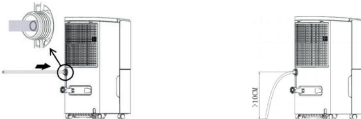
Vigyázat: a külsőleg csatlakoztatott tömlőt nem szabad a vízkimenetnél magasabba helyezni, és megfelelően kell nyújtani, különben fennáll a vízsivárgás veszélye.
