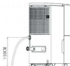
Uwaga: wąż podłączony zewnętrznie nie może znajdować się wyżej niż wylot wody i musi być odpowiednio wyprostowany, w przeciwnym razie istnieje ryzyko wycieku wody.
