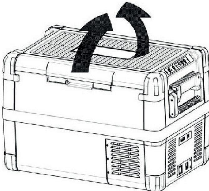
Der Deckel kann ganz entfernt werden, oder er kann von jeder Seite im Nu geöffnet werden, entweder nach links oder rechts.
