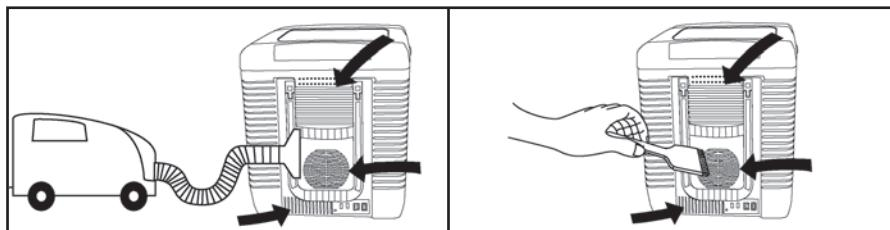
3. Staub und andere Verunreinigungen am Lüfter können die Kühlleistung reduzieren. Reinigen Sie diesen mit Hilfe vom Staubsauger oder mit einer Bürste.
