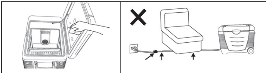
4. Uporaba naprave v visokih temperaturah in vlažnih okoljih lahko povzroči kapljjanje rose pod pokrovom - to ni napaka, obrišite s suho krpo.
